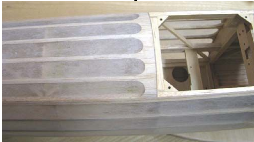
Bottom Stringer Fillets
